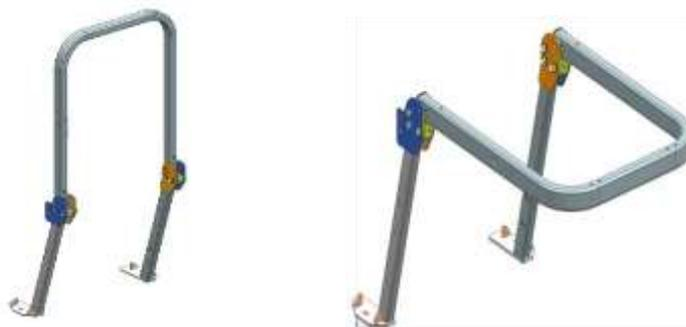
Схема для удлиненного положения противоопрокидывающей рамы
