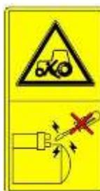
Значение: водитель должен запустить двигатель, находясь на сиденье водителя. Во избежание травм не запускайте двигатель при коротком замыкании на стартере;
