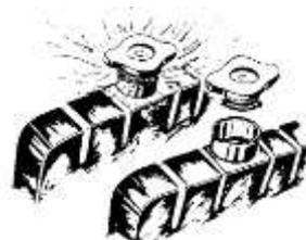
Отвинчивание крышки радиатора
