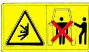
Значение: При работе механизма управления рычагом поднятия держитесь подальше от зоны действия подъемного рычага во избежание травм
